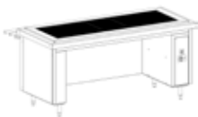
ÉLÉMENT CHAUD AVEC DESSUS EN VERRE TREMPÉ DESSOUS LIBRE 2 À 6 GN 1/1 OU SUR MESURE
