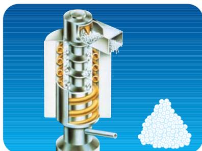
qui règne dans cette zone. Une vis sans fin en acier inoxydable située à l'intérieur du freezer entraînée par un motoréducteur en prise directe, achemine la glace en direction de son extrémité supérieure où l'excédent d'eau est expulsé de la glace par le broyeur au fur et à mesure que la glace est extrudée par le bec verseur.
