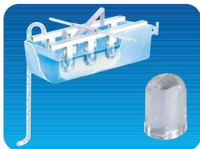
forment autour des doigts de l'évaporateur immergés dans l'eau. Lorsque les glaçons ont atteint l'épaisseur suffisante, les pales de l'agitateur se trouvent en contact avec eux, ce qui provoque une inversion de cycle et donc l'ouverture de la vanne gaz chauds vers l'évaporateur pour démouler les glaçons.
