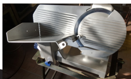
26/ Montage butée, lame, pare-lame et chariot
