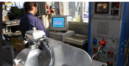
32/ Test électrique et de conformité avant le départ
