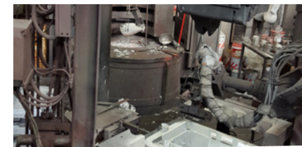
5/ ouverture du moule pour extraction du bâti coulé en une seule pièce
