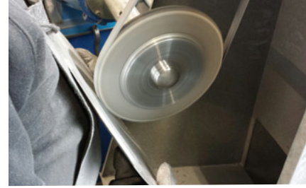
15/ Polissage des butées et de ses rainures
