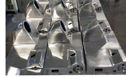
17/ Polissage bâti TG 350 façon miroir avant anodisation
