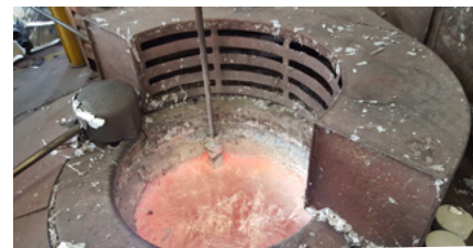
3/ aluminium en fusion dans le four
