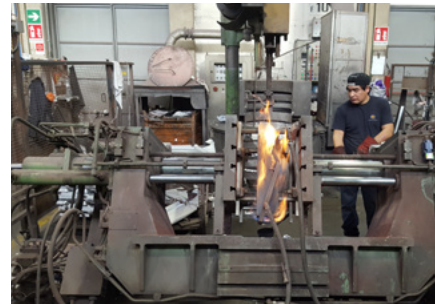
7/ Presse d'injection avec maintien en température du moule
