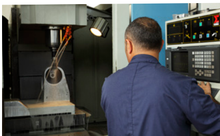
12/ Usinage des bâtis et de l'ensemble des pièces avant polissage et anodisation
