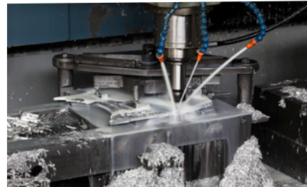
13/ Usinage butée et rainurage
