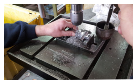
27/ Usinage du corps d'affûteur
