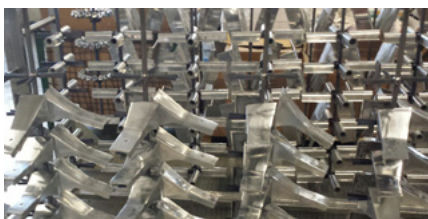
18/ Supports de chariot polis et dégagés du surplus d'injection
